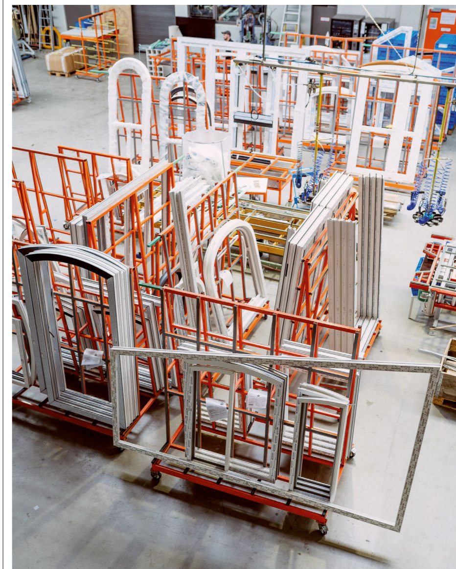
Vielfältige Formen in der Ventana Produktion – das Biegen der PVC-Profile gehört nach wie vor zur Kernkompetenz des Sonderfenster-Spezialisten.
